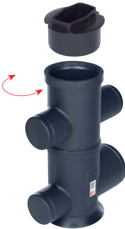
събирателна шахта с кошница за едри отпадъци и адаптор за свързване вертикално под улея, отвори за DN / OD 110 или DN / OD 160
